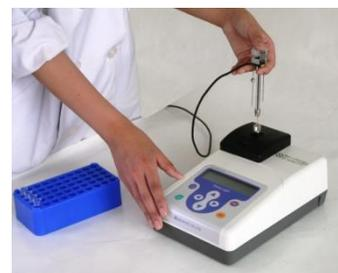
GL-220Sはシリンジで測定中の試薬分注が可能
