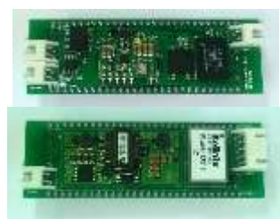
電源ボード ML100-PS (画像は表面および裏面)
