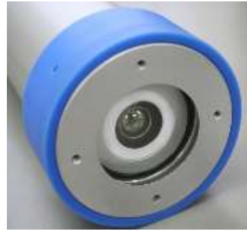
深海用微弱光測定装置 (東京大学様・海洋研究開発機構様 JST/CREST)
