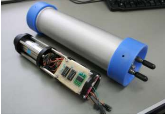
深海用微弱光測定装置 (東京大学様・海洋研究開発機構様 JST/CREST)
