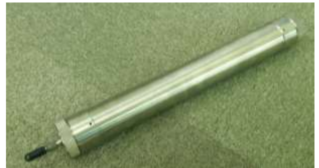
深海 濁度センサー用ロガー (高知大学様 JST 先端計測分析技術・機器開発プログラム)
