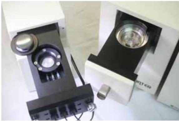
測定室が前後引き出し式になっているので操作性が良く、高い遮光性を持ち、恒温・攪拌・分注などさまざまなオプションに対応が容易な 30mm x 75mmH の広い測定室を確保しています。
